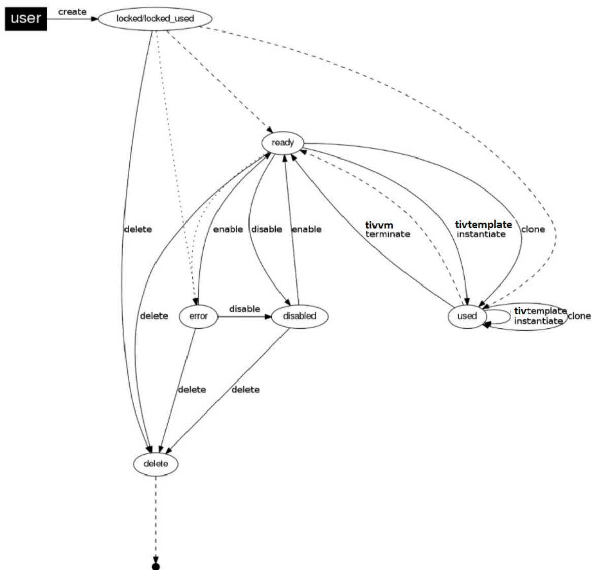
Рис. 5.2 – Диаграмма состояний непостоянного образа диска VM
